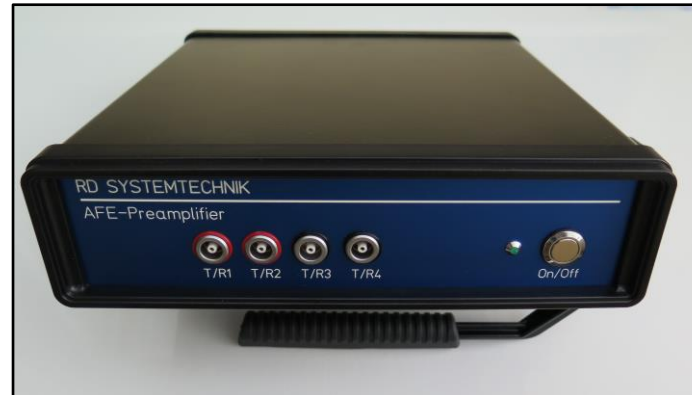
AFE - Vorverstärker 4 - Kanal (extern)
