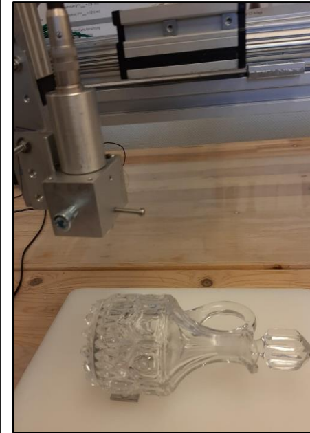
Oberfläche/Textur: Glas mit komplexe Form, Luftschall 750 KHz
